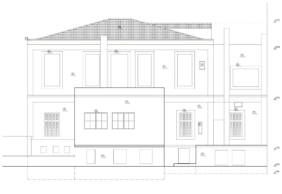
Εικ. 4.1.Η. Πίσω όψη υπάρχουσας κατάστασης διατηρητέου κτιρίου
